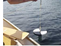
Disco de Secchi: analisa a transparência da água
