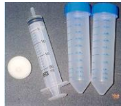
Material para coleta de água: 2 tubos para centrifuga, unidades filtrantes e seringa descartável sem agulha
