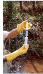
Coleta da amostra de água (observar a posição da seringa entre a seringa e o tubo)
